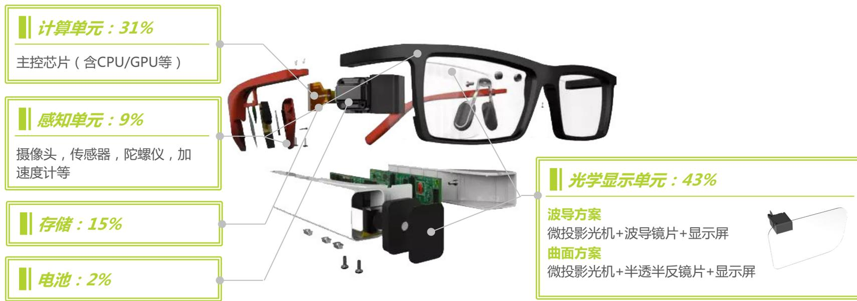
注释：图示为阵列光波导下的AR整机设备拆解图，作注处为模组可能设置的位置供参考，不同光学方案的AR整机设备形态不同；BOM占比拆分参考微软Hololens，仅供参考。
